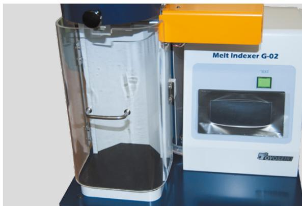
回転刃や試料への接触と、サンプルの飛散や紛失を予防します。
