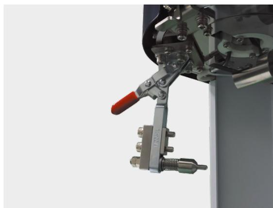
溶解粘度が低く自重で流れ出てしまう試料に対してオリフィスを押さえて流出を防ぎます。
