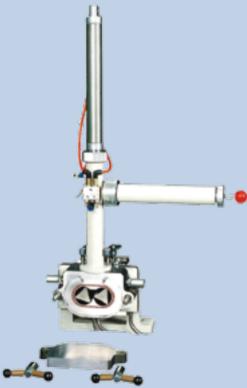
Fig.8 窒素パージシリンダーホッパー VHCN型(60cc用、100cc用) 試料を入れたチャンバー内を窒素 パージ状態や、真空状態(絶対圧 力1～5KPa、250℃以下)に しエアシリンダー式ラムで加圧 しながら試験できる。 (No.2ブロックは丸穴式)。 機体寸法：約 W180×D300× H910mm
