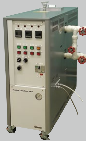
Fig.7 油循環槽 OP3 型 油加熱式バンバリーミキサー (BR250型、BR600型)用循環槽 機体寸法：約 W380×D830× H1210mm 質 量：約 75kg 安全装置：油面低下による空だき防 止用フローセンサー過 昇温防止用センサー
