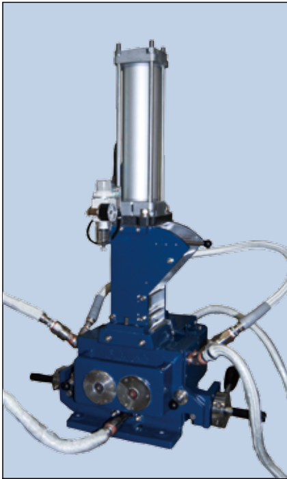
Fig. 12 油加熱式バンパリーミキサー (BR250型、BR600型)
