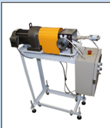
Fig. 26 ギヤポンプ GP2 型 構成：GP2 + 圧力検出 2 個 機体寸法：約 W650 × D730 × H1300mm
