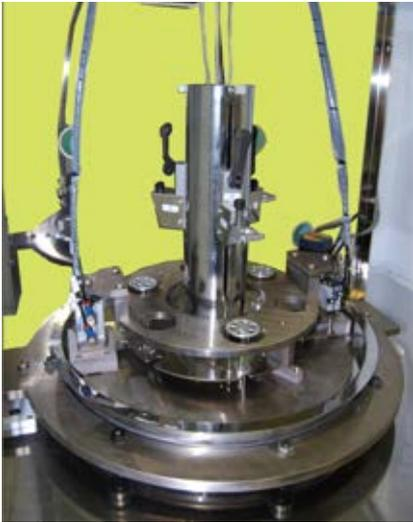
試験片の温度分布向上のため槽内エアの流れを制御し、試験片の配置を改良しました。
