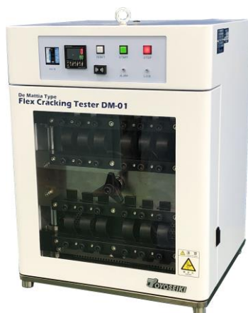
No.255 デマテア フレックスクラッキングテスタ 型式 DM-01
