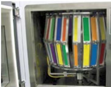
オプションの2段ラックは、合計60個のホルダーを掛け暴露することが出来ます。(但し、BPTもしくはBSTセンサーと、ダミーサンプルをラックにかける為、実質は58個のサンプルを暴露します) 独特な傾斜型ラックにより、サンプル表面へ万遍なく光照射、均一な温度コントロールが可能です。この2段ラックは、現行のCi3000+に搭載可能です。
