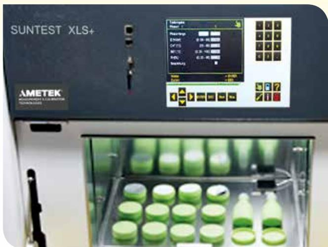
フラットベッド型の試験機は、ほぼあらゆる形状、大きさの試験に対応します。試料温度を下げるオプションは、熱に敏感な製品、医薬品、化粧品の光安定性試験に役立ちます。
