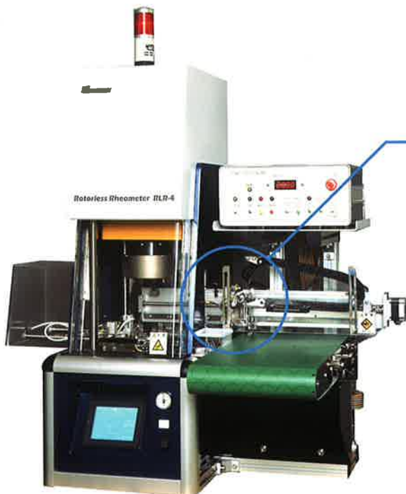
Fig.5 全自動化システム (試料自動着脱装置ROB-R4、データ処理装置CON-L、専用テーブルDAI-Lの組合せ)
